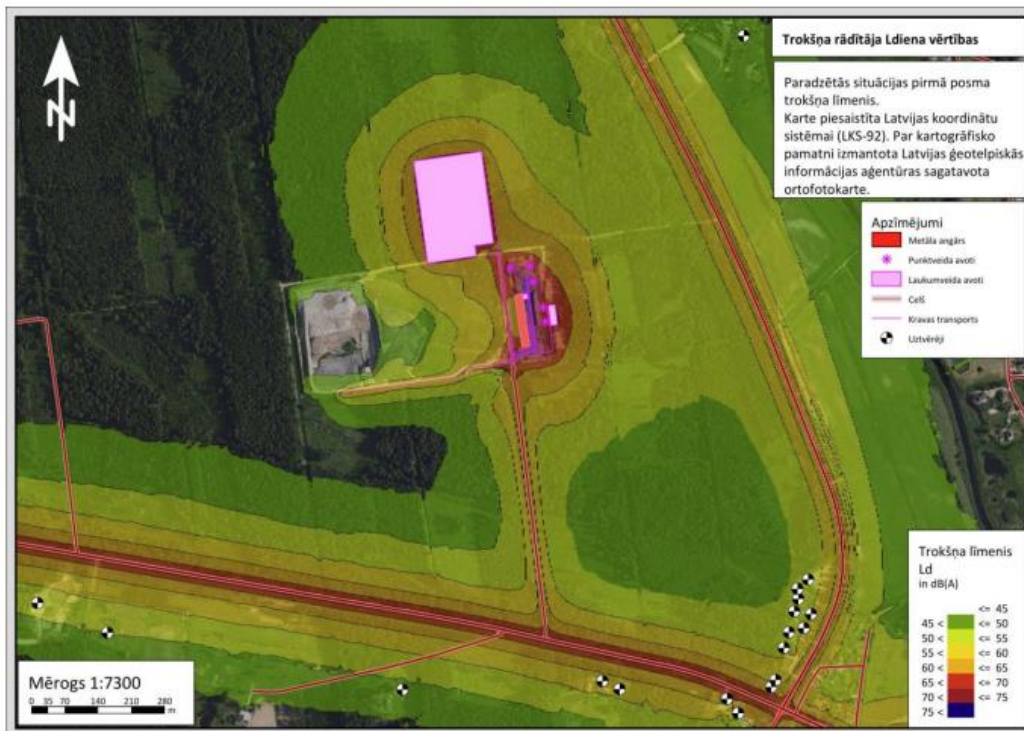
5. attēls. Ldiena kopējais trokšņa līmenis sadzīves atkritumu poligona "Brakšķi" ietekmes zonā (7:00-19:00), dB(A) (avots: SIA "Vides eksperti" "Trokšņu ietekmes novērtējumu sadzīves atkritumu poligona "Brakšķi" infrastruktūras paplašināšana (jaunas atkritumu krātuves izveide) Līvberzes pagastā, Jelgavas novadā", 2023. g.)
