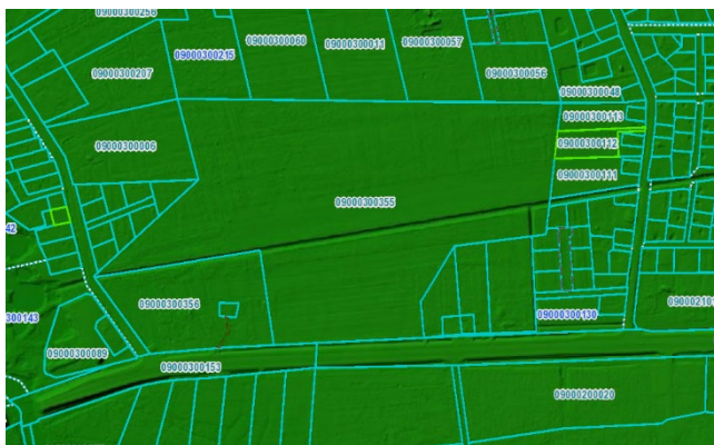
14. attēls. LIDAR zemes reljefa un slīpuma modelis ar augstuma atzīmēm. Avots: https://www.lvmgeo.lv/kartes
